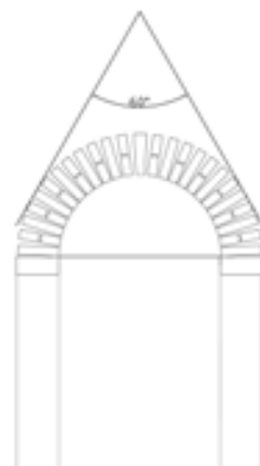
Meccanismi di dissesto degli archi. Porzione di muratura effettivamente sostenuta da un arco a tutto sesto.
